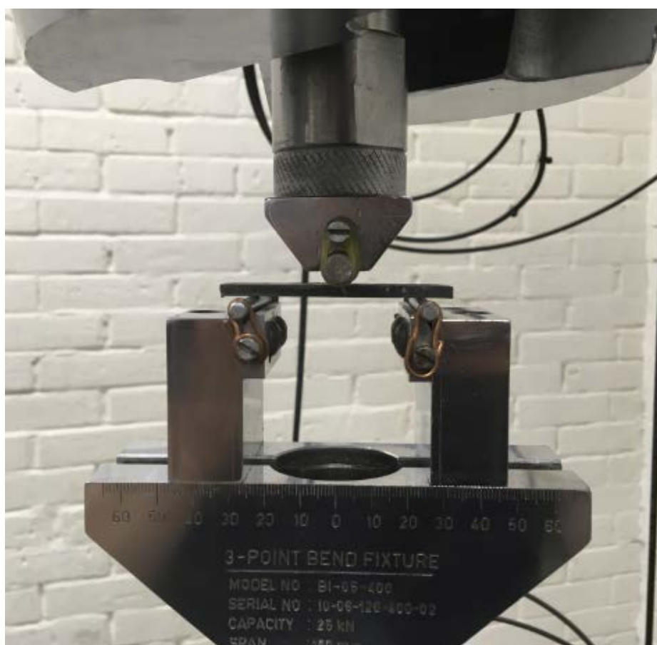
Рисунок 7.2. Вид элементарного образца при испытаниях на трехточечный изгиб
