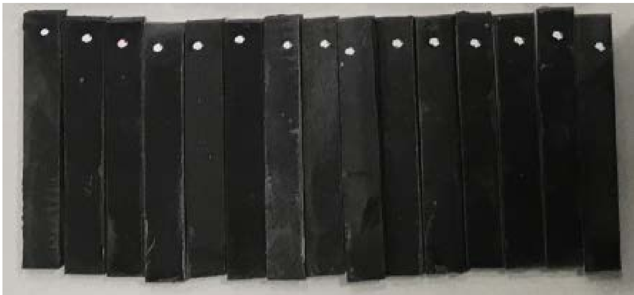
Рисунок 6.2. Вид элементарных образцов до климатических и механических испытаний
