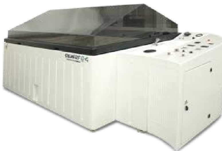
Рисунок 6.4. Камера соляного тумана CME Silver Fog 2000
